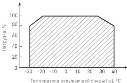
Рис. 2. Максимальная допустимая нагрузка, % от мощности источника
