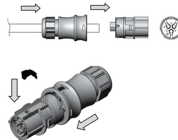
3.2. Подключить коннектор к ответной части, установленной на корпусе светильника. Установить заземляющий провод.
